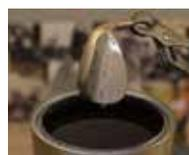
Una vez ha finalizado el tratamiento, la cabeza de wedge se sumerge en un acabado de óxido para lograr un aspecto lujoso y añadir una capa extra de protección sobre el material de la cabeza. De este modo se evita cualquier corrosión antes de que el wedge llegue al cliente.
