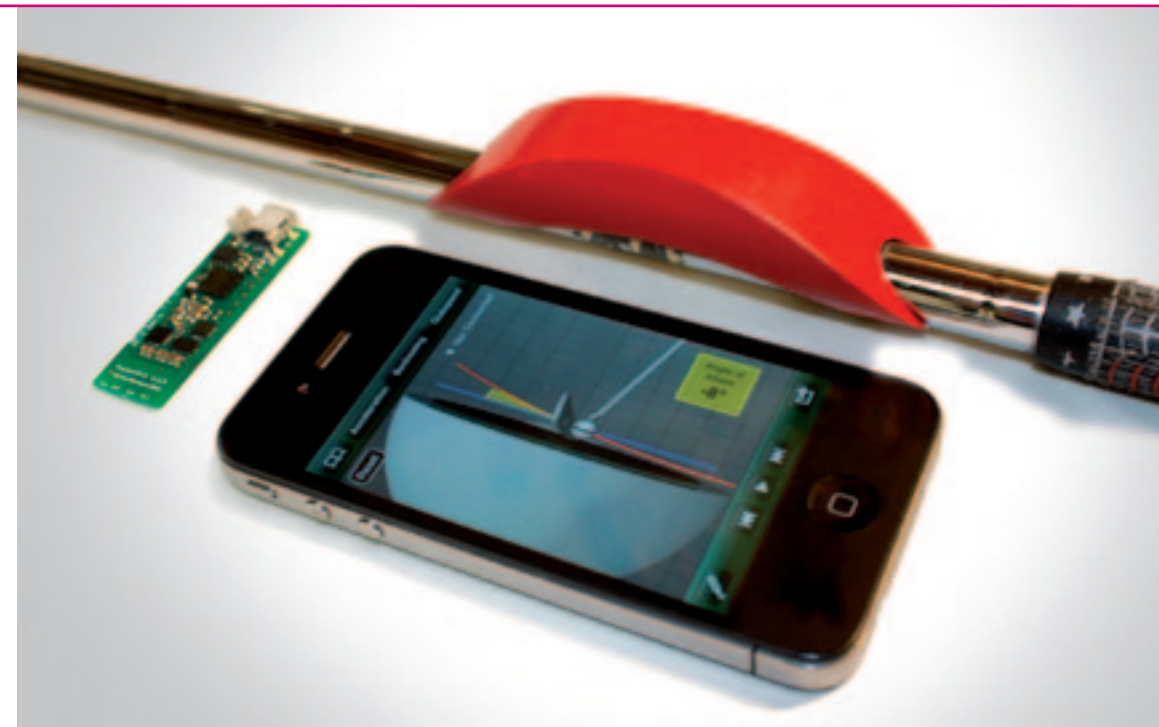
Arriba: Los componentes del Pocket Pro ocupan muy poco espacio -el componente más grande es el propio teléfono móvil-. Abajo: Análisis del swing en 3D y en gráficos
